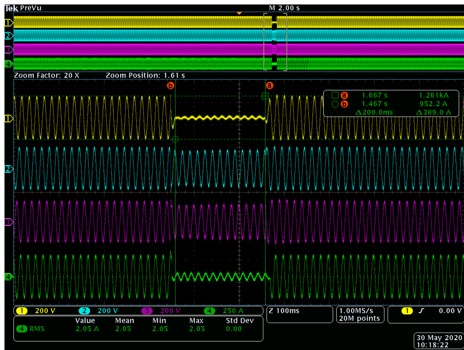
7 - não simétrica falha duas fases Asymmetric two phases failure
