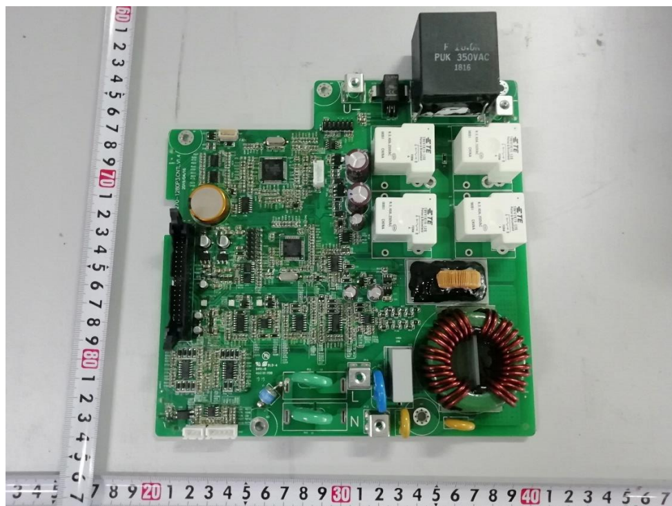
Figura 12. Vista lateral da placa de saída e da placa de controle para R5-8K-S2 Figure 12. Output board and Control board component side view for R5-8K-S2
