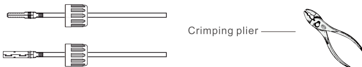
Figura 5.4 Crimpe o pino de contato no fio
