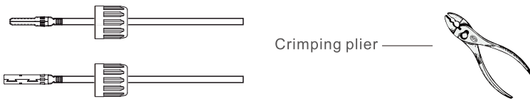
Figura 5.4 Crimpe o pino de contato no fio
