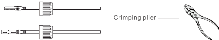
Figura 5.4 Crimpe o pino de contato no fio
