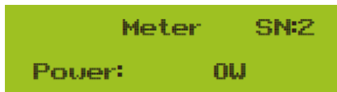
Figura 7.3 Configuração de Parâmetro Quando o medidor CHINT está conectado, este mostra SN:2
